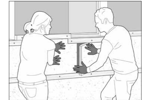
Įstatykite termoizoliaciją tarp tašų. Užtikrinkite, kad neliktų tarpų tarp tašų ir termoizoliacijos bei atskirų termoizoliacijos plokščių.
